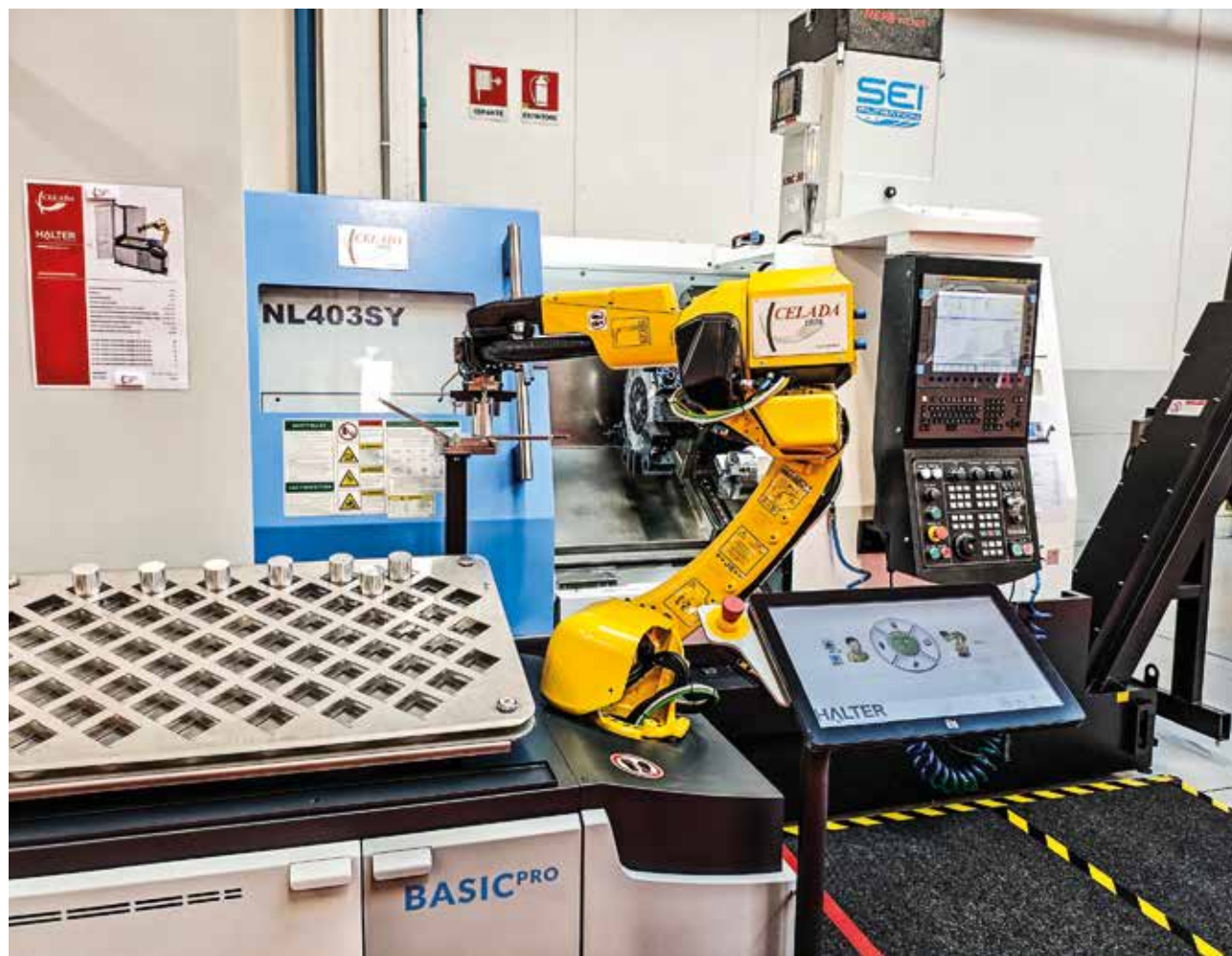
Centro di tornitura Neway equipaggiato con automazione per il carico/scarico dei pezzi.
